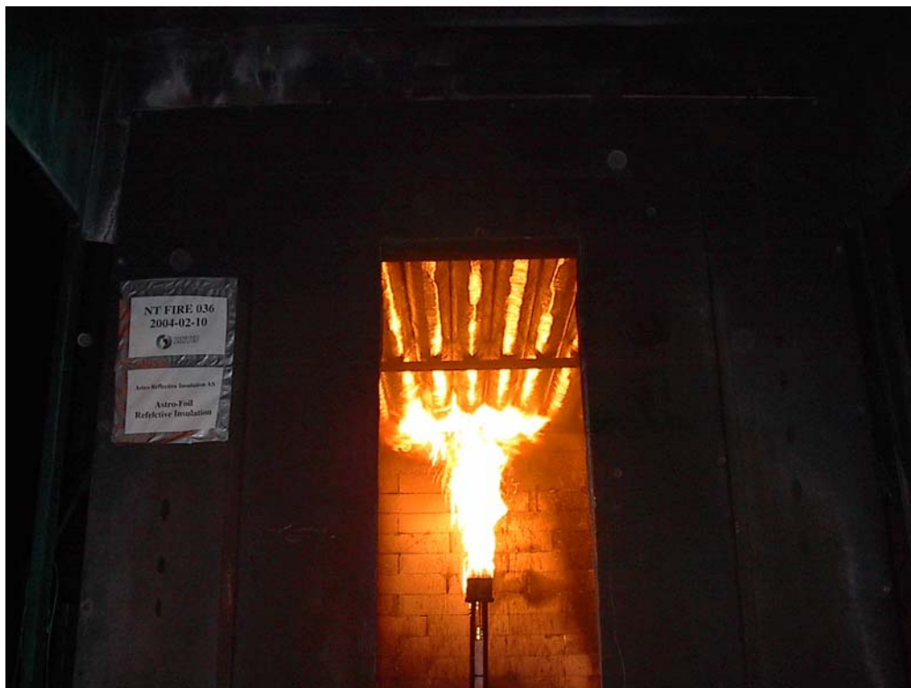
Foto 2 Astro-Foil Reflective Insulation etter 1 min prøvingstid
