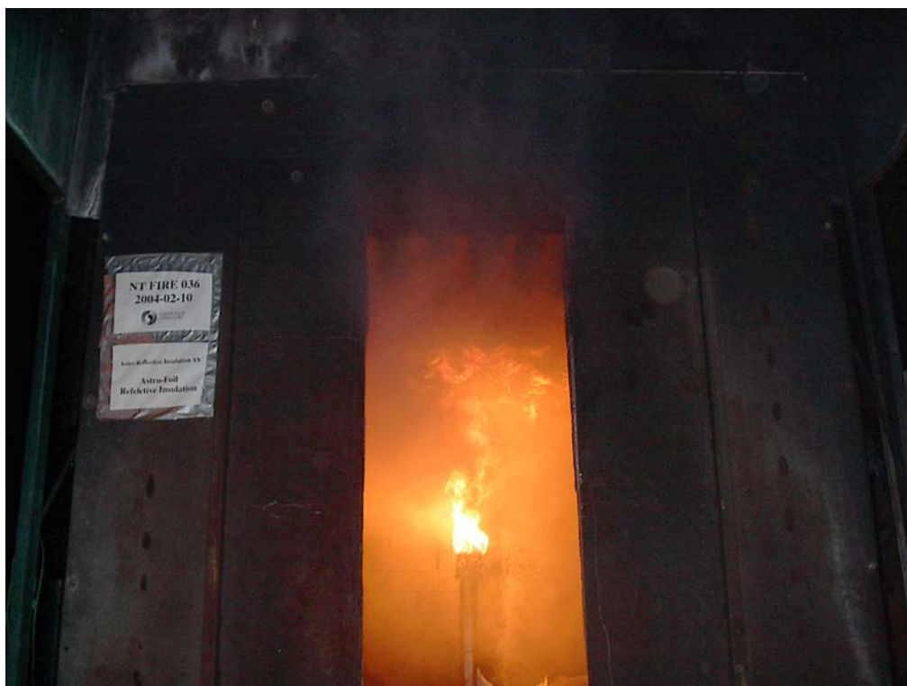
Foto 3 Astro-Foil Reflective Insulation etter 1 minutter og 40 sekunders prøving.
