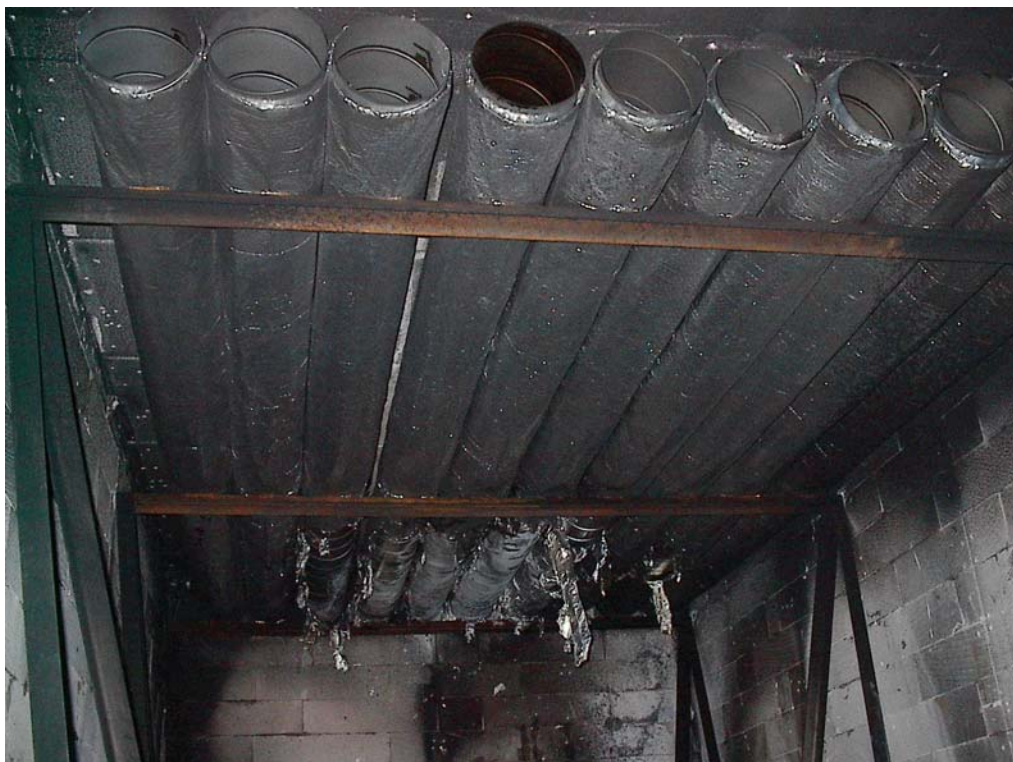
Foto 7 Astro-Foil Reflective Insulation etter prøving
