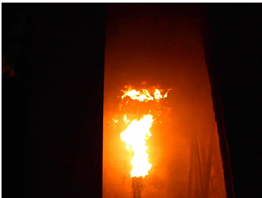
Foto 6 Astro-Foil Reflective Insulation etter 13 minutters prøving.
