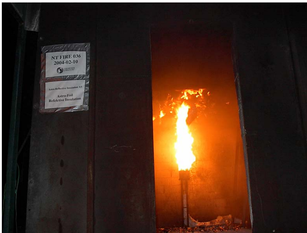
Foto 5 Astro-Foil Reflective Insulation etter 10 minutters prøving.
